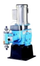
Una bomba dosificadora con diafragma hidráulico tubular de baja a media capacidad. Capacidades hasta los 23 lph y contrapresiones de 21 Kg/cm2. Un segundo cabezal de control independiente puede ser agregado a la caja de engranaje para duplicar la capacidad o aplicar un segundo reactivo. Válvula de alivio de presión interconstruida y un sistema hidráulico automático que le asegura una operación larga y sin problemas.
