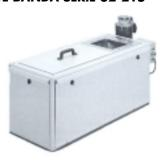
Un dosificador volumétrico de alta capacidad que maneja material que va desde polvo fino hasta grumos de 38mm. Su banda de velocidad variable le permite un rango de operación estándar de 20:1 a una capacidad máxima de 23.7 m3/hr.
