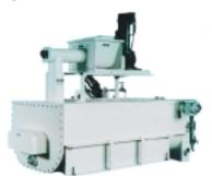
Un exclusivo hidratador de cal tipo pasta para proporción de agua cal a 2:1 para una soltura más eficiente que produce hidrato más reactivo que el rango convencional a los apagadores tipo borroso de 4:1. Se disponen de 4 capacidades hasta los 3.6 ton/hr en una gama de operación de 20:1. están disponibles hasta 8,000 libras por hora con un rango estándar de operación de 20:1.
